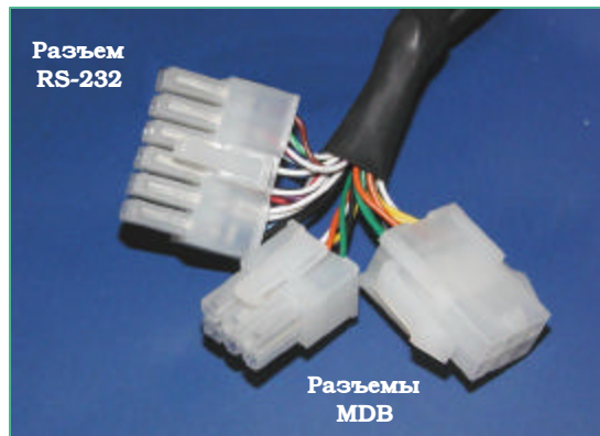
Иллюстрация 9. Головная часть валидатора Аигога – идентификация разъемов
