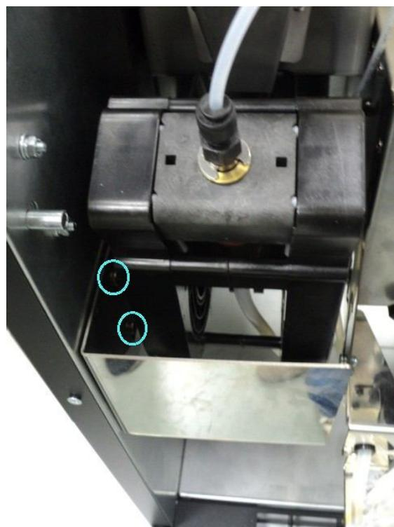
Рисунок 5 — Установка отбойника
