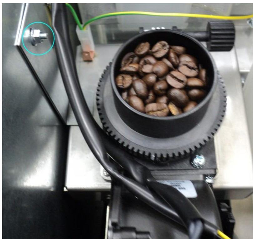
Рисунок 3 — снятие транспортной скобы
