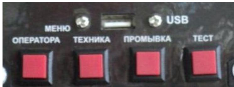
Рисунок 28 — 4x-кнопочная клавиатура быстрого доступа
