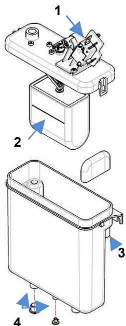
Рисунок 23 — поплавковая камера.
