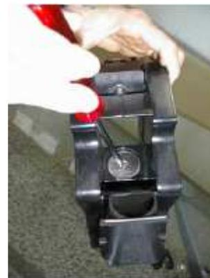
Снять нижний фильтр, фильтр наверх, снять камеру в сторону выброса и промыть горячей водой, удаляя с него кофе.
