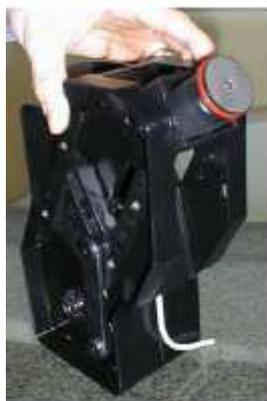
Повернуть верхний фильтр наверх, снять камеру в сторону выброса.
