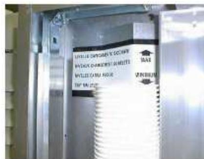
Край последнего сверху стаканчика должен находиться внутри отрезка, обозначенного наклейкой на диспенсоре. Это позволит механизмам внутри диспенсора правильно работать.
