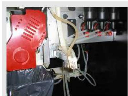
Моторедуктор вращает винтовой механизм в контейнере с сахаром, который всыпает соответствующее количество сахара в дозировщик. Сервомотор приводит в движение и останавливает дозирующее плечо, после чего сахар всыпается в стаканчик.
