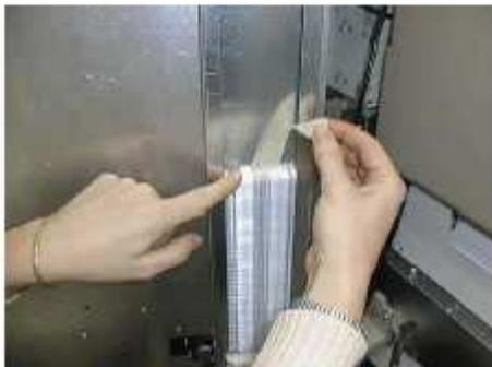
Вставить размешиватели, скрепленные резинкой, вдоль направляющей детали. Когда они дойдут до конца направляющей, перерезать резинку.
