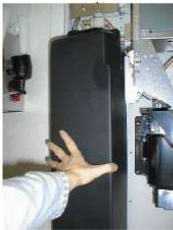
Снять крышку механизма монет
