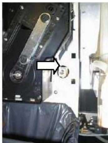
вынуть трубку, подводящую воду к заварочной камере;
