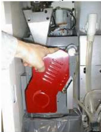
снять красную заварочной камеры;
