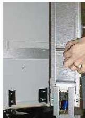
Снять металлический груз.
