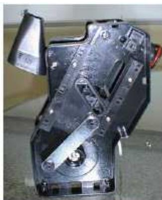
Повернуть заварочную камеру и промыть использованного кофе иудаляя с него кофе. горячей водой, повернуть желоб для удаляя с него кофе. кофе.
