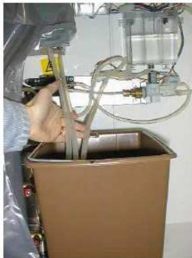
В автоматах версии E и FB открутить заглушку на нижней крышке проточного бойлера и подождать, пока он будет пустой. Использовать емкость для жидких отходов под использованную воду.
