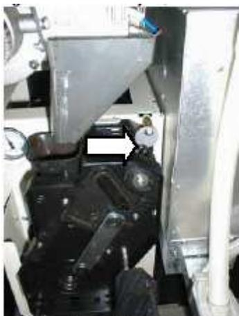
снять с крючка заварочную камеру, поворачивая рычаг;
