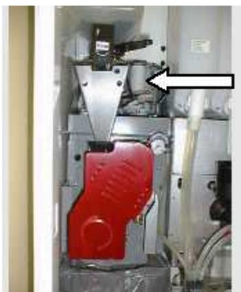
2) Включается электромагнит дозатора, сбрасывающего кофе, контейнер открывается. Нужное количество кофе попадает в заварочную камеру модуля эспрессо-группы \*
