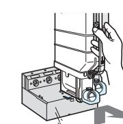
2.Потяните за крышку емкости и снимите ее.
